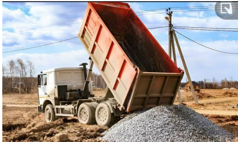
Gambar 2.9 Alat Pengangkut Material Dam Truk
