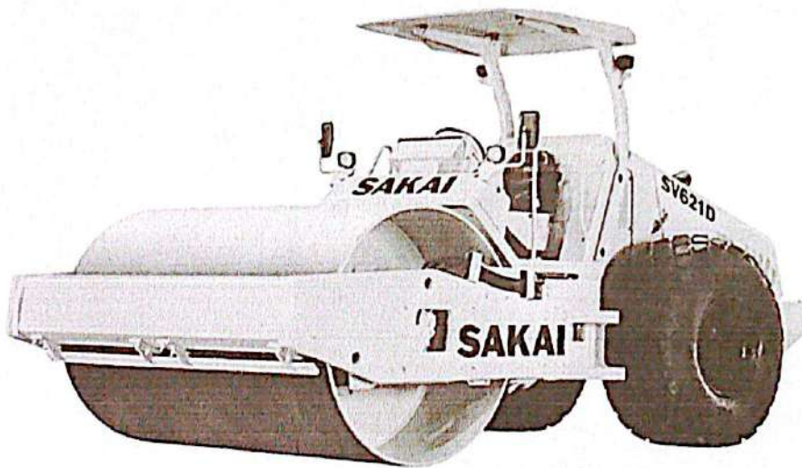
Gambar 7: compactor _ alat pemadat tanah pada pekerjaan landasan pesawat terbang, dan jalan raya
